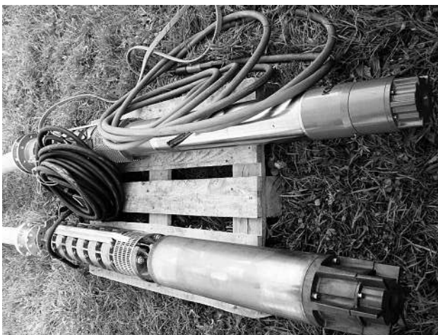
Oben: neue Pumpe 3 Unten: alte Pumpe 3
