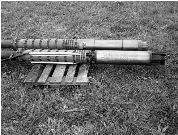
Ausgebaute Pumpen 3 und 4
